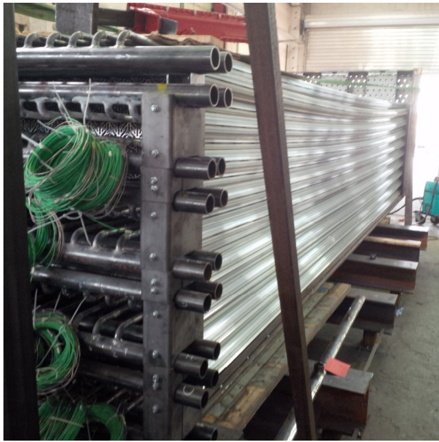
Abbildung 5: Bau des Latentwärmespeichers
